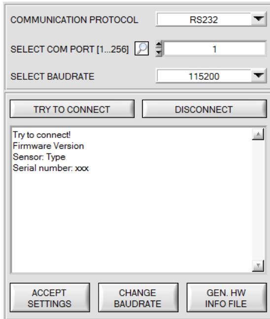
Die Baudrate zur Datenübertragung über die RS232 Schnittstelle kann mit **SELECT BAUDRATE** und **CHANGE BAUDRATE** eingestellt werden.
