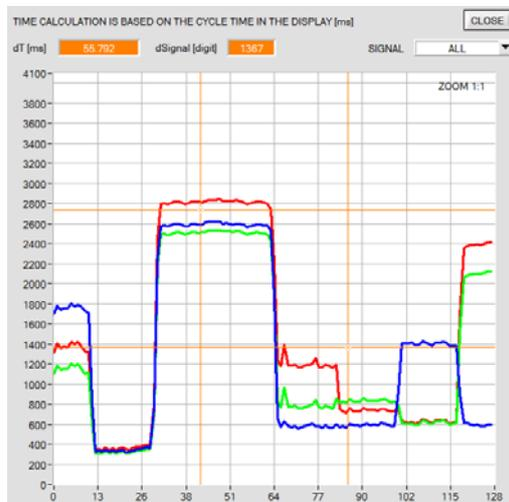
Durch Halten der Steuerungstaste Strg (CTRL) und Aufziehen eines Fensters mit der Maus im Graphen kann in den Graphen gezoomt werden.
