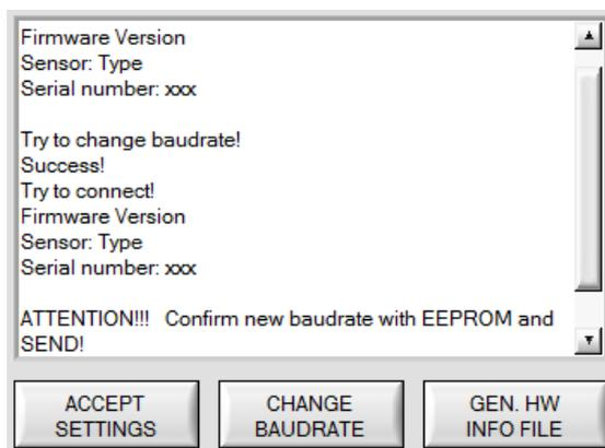
Nachdem die neue Baudrate erfolgreich übertragen worden ist arbeitet der Sensor mit der neuen Baudrate. Außerdem erscheint im Anzeigefenster eine Aufforderung **EEPROM** zu selektieren und anschließend **SEND** zu drücken. Erst nach Drücken von **EEPROM** und **SEND** wird bei einem Hardware-Reset mit der neuen Baudrate gestartet.
