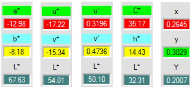
In diesen Zahlenwert Displays werden die aus den Normfarbwerten X, Y, Z berechneten Farbkoordinaten und Helligkeitswerte angezeigt. Die Berechnung erfolgt wie in C SPACE beschrieben.
